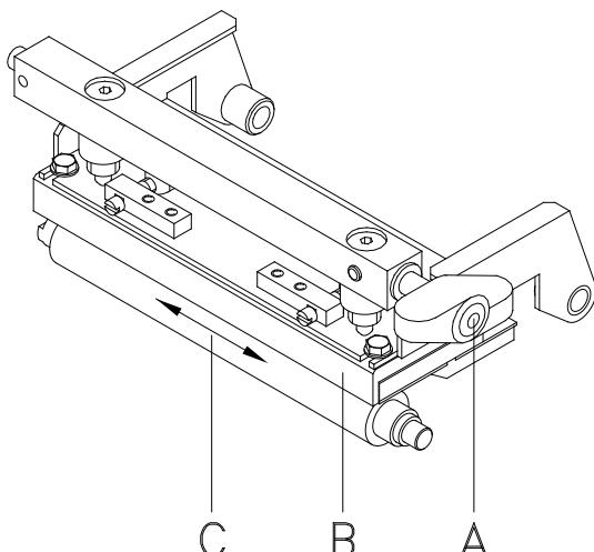
Znečištění tiskového válce vede ke zhoršení jakosti tisku a kromě toho může vést k omezení dopravy materiálu.
