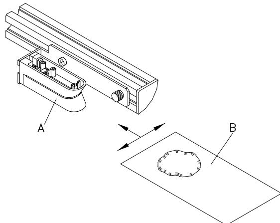
Die Etikettenlichtschranke kann durch Papierstaub verschmutzen. Dadurch kann die Etikettenabtastung beeinträchtigt werden.
